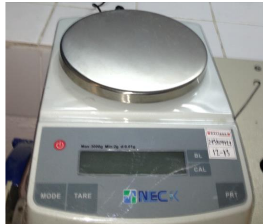
Fotoğraf 3.46. ve 3.47. Arşimed deney düzeneği ile hassas terazide ağırlık ölçümü ve yoğunluk hesabı
