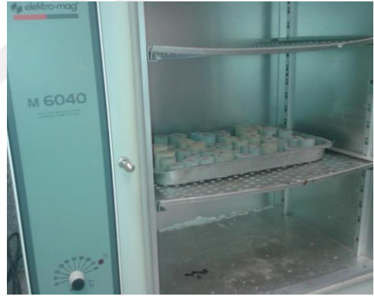
Fotoğraf 3.44. ve 3.45. Fiziksel deneyler su emme testi ve etüde nem alma işlemi
