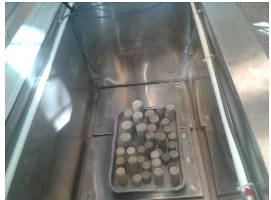
Foto 3.38. ve 3.39. Örneğin çevrimli donma çözölme testi için hazırlama iřlemi
