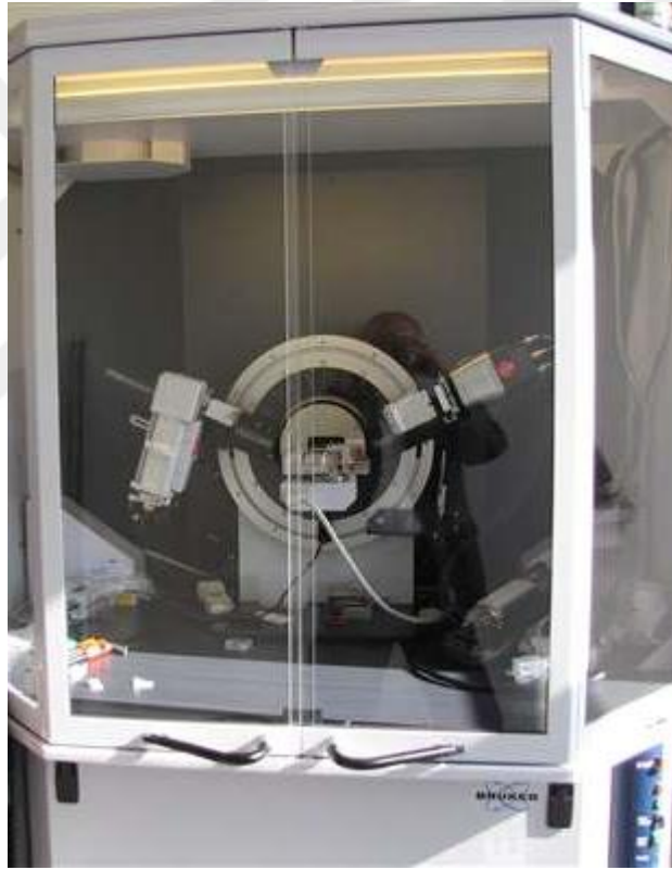
Fotoğraf 3.33. XRD cihazı (İ.T.Ü. JAL Lab.)
