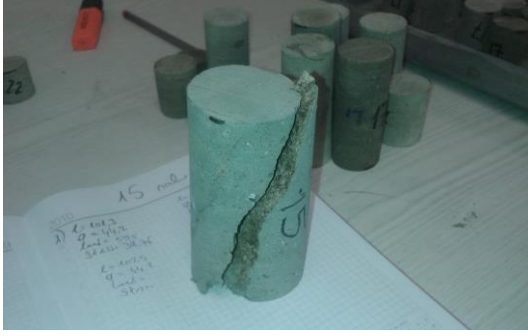
Fotoğraf 3.40. ve 3.41. Tek eksenli basınç dayanım testinde yük altında kırma işlemi
