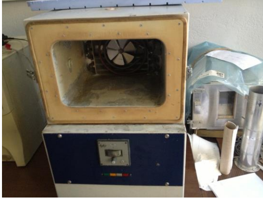
Fotoğraf 3.58. ve 3.59. Su buharı difüzyon direnç faktörünün ölçülmesi
