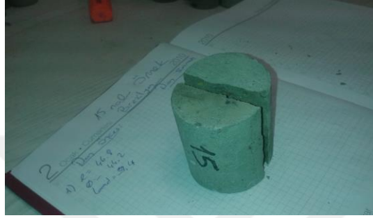
Fotoğraf 3.42. ve 3.43. Brezilyan çekme deneyi ile çekme dayanımının hesaplanması
