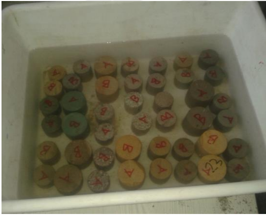
Fotoğraf 3.44. ve 3.45. Fiziksel deneyler su emme testi ve etüde nem alma işlemi
