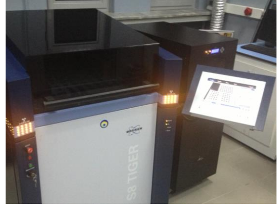
Fotoğraf 3.30. X-Ray Floresans cihazı Fotoğraf 3.31. XRF analizi
