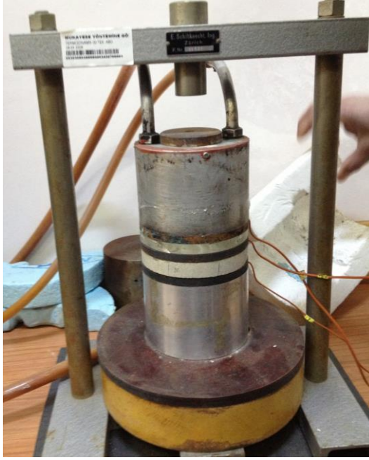
Fotoğraf 3.50. ve 3.51. Mukayese yöntemine göre ısı iletkenlik katsayısı tayin deney düzeneği (İ.T.Ü. Makine Fakültesi Termodinamik Laboratuvarı) Sıcaklık farklarının ölçülerek ısı iletkenlik katsayısının hesaplanması
