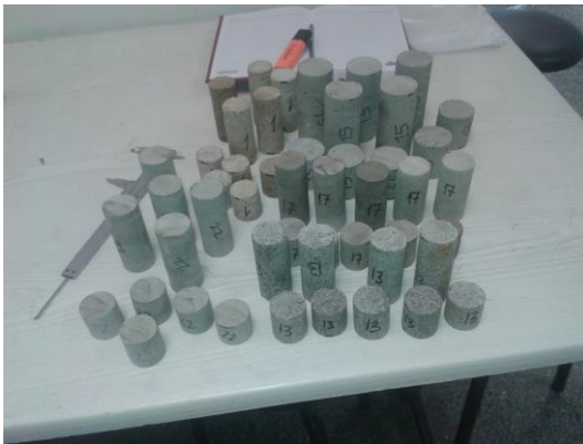
Foto 3.38. ve 3.39. Örneğin çevrimli donma çözölme testi için hazırlama iřlemi
