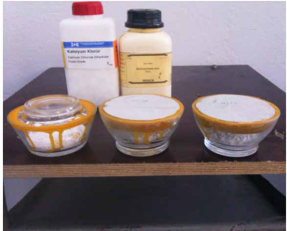
Fotoğraf 3.56. ve 3.57. Su buharı difüzyon direnç faktörünün ölçülmesi
