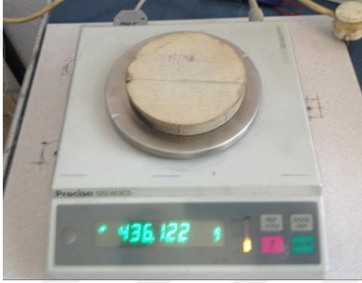
Fotoğraf 3.54. ve 3.55. Su buharı difüzyon direnç faktörünün ölçülmesi
