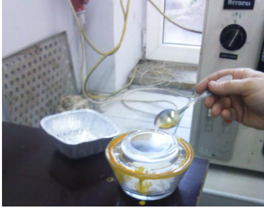
Fotoğraf 3.52. ve 3.53. Su buharı difüzyon direnç faktörünün ölçülmesi
