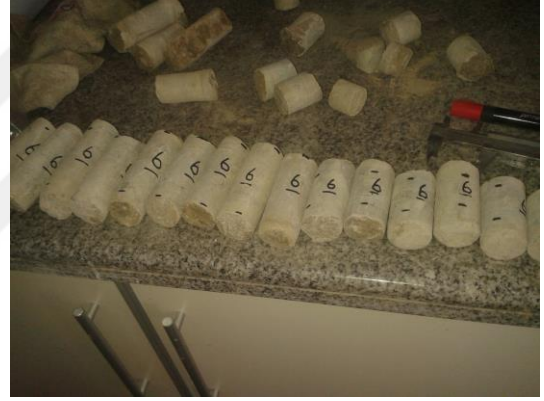
Fotoęraf 3.36. ve 3.37. Örneğin numaralandırılması, uçlarının düzeltilmesi iřlemi
