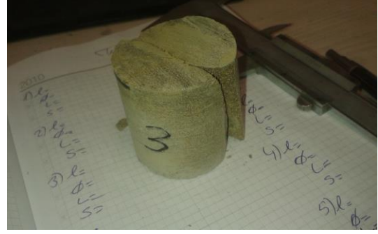
Fotoğraf 3.40. ve 3.41. Tek eksenli basınç dayanım testinde yük altında kırma işlemi
