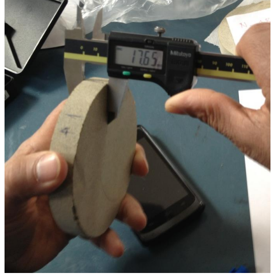
Fotoğraf 3.48. ve 3.49. Örneklerin (18 ve 22 nolu) ortalama çap ve ortalama kalınlık ölçümü
