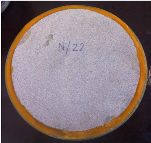
Fotoğraf 3.56. ve 3.57. Su buharı difüzyon direnç faktörünün ölçülmesi
