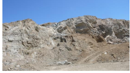
Foto. 2.43.-2.44. GPS-16’da taş ocağı ve aynası, çatlak ve kırıklıklar ile masif yapılar GPS-16’da 13 nolu örnek temininde, bloктаş-parça üretilmiş olan taş ocağı ve aynası ile çatlak, kırıklıklar ve masif yapılar detaylı olarak görülmektedir (Foto. 2.45-2.46).
