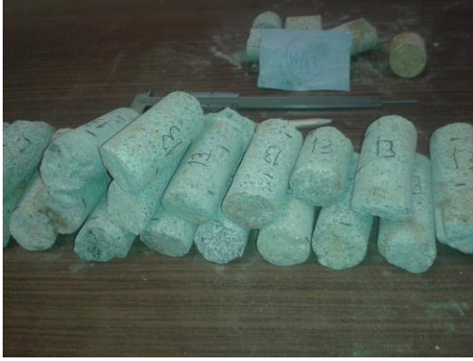
Fotoęraf 3.36. ve 3.37. Örneğin numaralandırılması, uçlarının düzeltilmesi iřlemi
