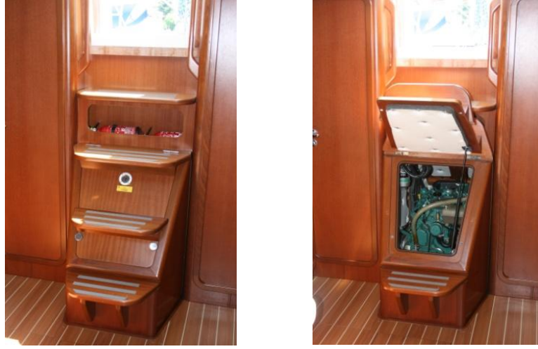
Şekil 2.97. Kabin giriş merdiveninin altında bulunan motor bölümü
