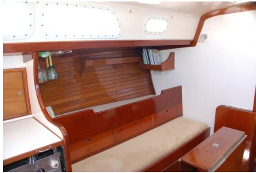
Şekil 2.74. Oturma elemanı arkasında bulunan yatak (Pilot berth)
