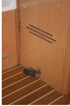
Şekil 2.45. Kuzinede mekanik ayak pompasının pedalı
