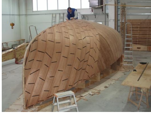
Şekil 1.36. Diyagonal lamine epoksi kaplama yöntemi
