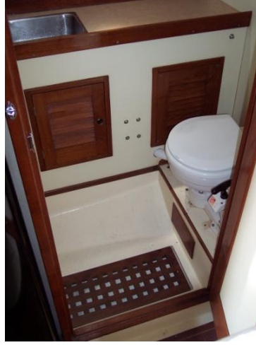
Şekil 2.85. Duş fonksiyonuna yönelik sökülebilir ızgara taban
