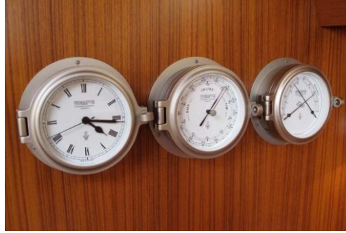
Şekil 1.60. Saat, barometre, termometre ve nemölçer
