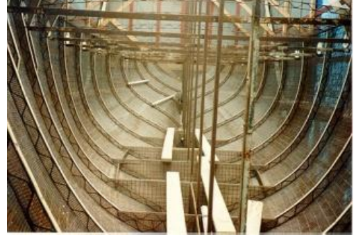
Şekil 1.46. Çelik iskeletin çubuklar ve galvaniz tellerle örülmüş görünümü
