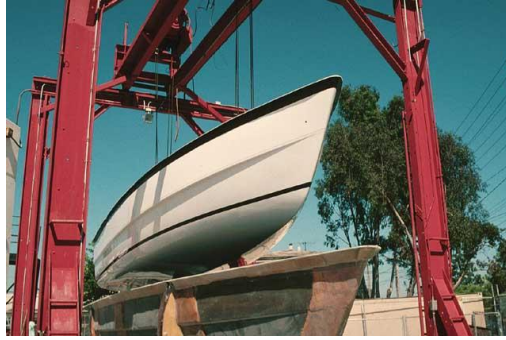
Şekil 1.45. Aslı gövdenin kalıptan ayrılması
