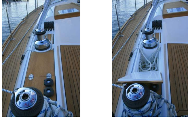
Şekil 3.6. Havuzlukta halatlar için ayrılan bölme
