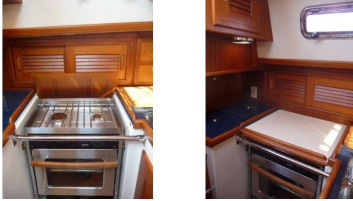
Şekil 3.23. Ocağın üzeri kapanarak çalışma alanı olabilmektedir
