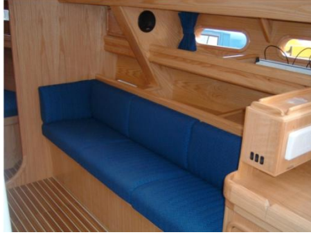
Şekil 3.35. Oturma elemanı, açık depolama alanı ve sabit lumbuzlar
