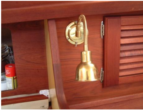
Şekil 2.150. Gece seyrinde hareketli lamba ile dolap içi aydınlatması
