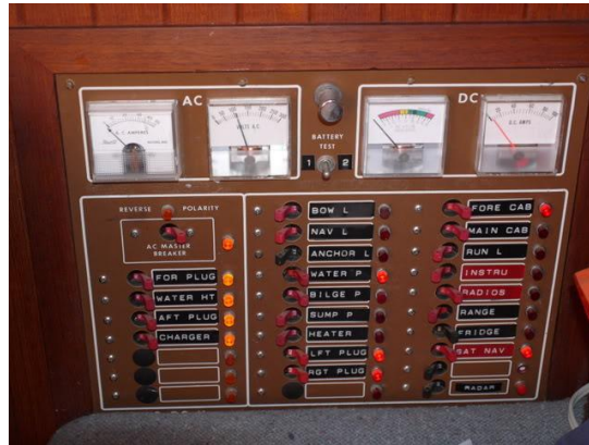
Şekil 2.118. 12 ve 220 volt otomatik sigortalar ve göstergeleri
