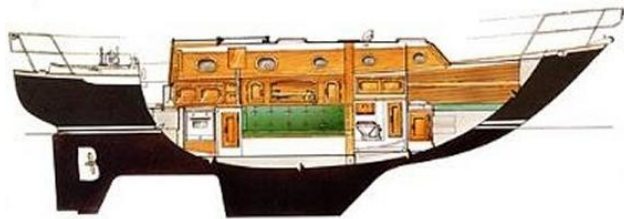
Şekil 3.17. Pacific Seacraft 34'ün gövde yapısı
