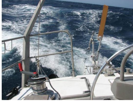
Şekil 2.10. Rüzgar dümeni ile seyir halinde bir yelkenli
