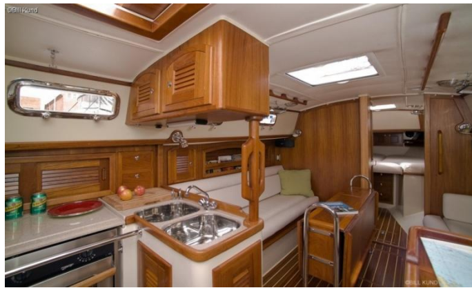
Şekil 3.22. Kuzinede eviye ve üst dolap
