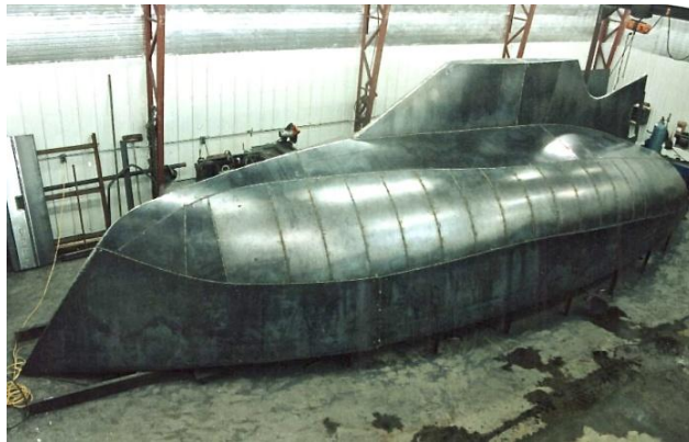
Şekil 1.41. Yuvarlak karinalı bir sac gövdenin yapım aşaması
