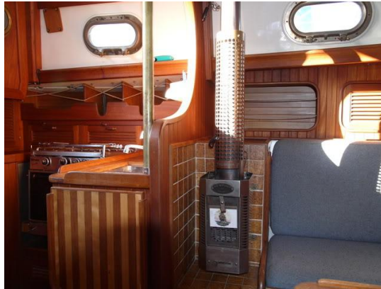
Şekil 2.144. Kerosen ile çalışan bir tekne sobası
