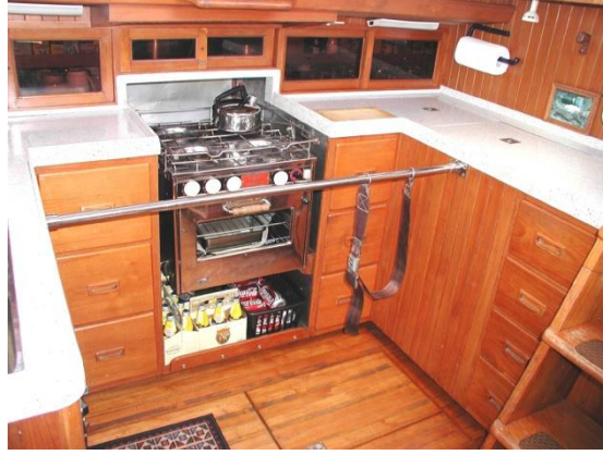
Şekil 2.59. Kuzinede eller serbest çalışabilmek için kullanılan kuşam
