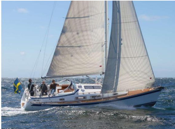
Şekil 3.2. Tekne sloop armaya sahiptir
