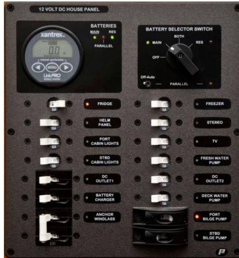
Şekil 2.117. 12 volt otomatik sigorta paneli
