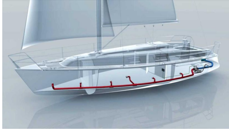
Şekil 2.146. Sıcak havanın kanallarla bölmelere iletilmesi
