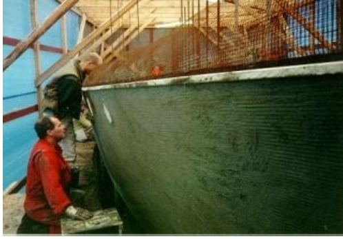
Şekil 1.47. İskeletin üzerine beton döküm işlemi
