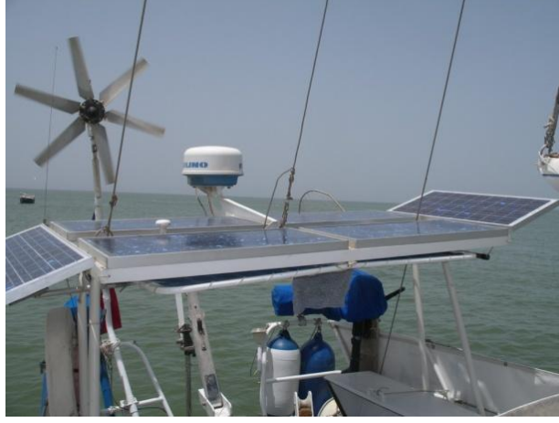
Şekil 2.114. Güneş panelleri ve rüzgar jeneratörü
