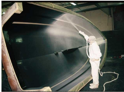
Şekil 1.43. Kalıba jelkot püskürtme işlemi
