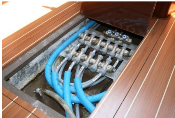
Şekil 2.130. Sintinede bulunan su dağıtım şebekesi
