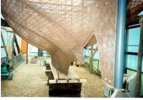
Şekil 1.46. Çelik iskeletin çubuklar ve galvaniz tellerle örülmüş görünümü
