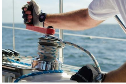
Şekil 2.104. Havuzlukta vinç kullanımı
