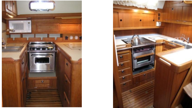
Şekil 2.58. U ve L şeklinde kuzine yerleşimleri
