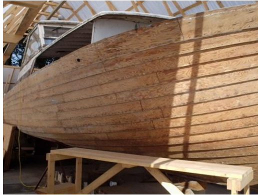
Şekil 1.37. Geleneksel bindirme kaplama yöntemi
