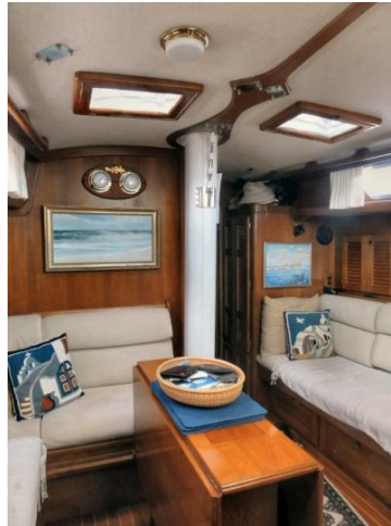
Şekil 2.30. Oturma elemanının arkalığı direk ile aynı hizaya getirilmiş
