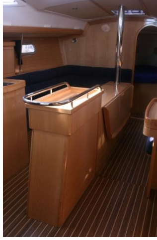
Şekil 2.36. Tezgah olarak da kullanılan kasa üzerindeki tutamaklar
