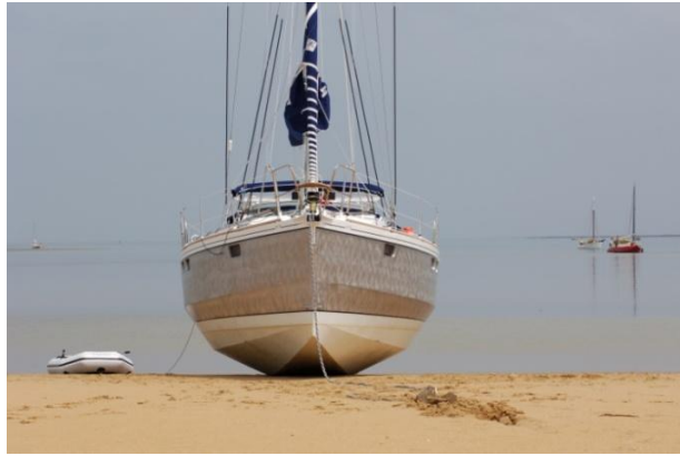
Şekil 3.28. Çeneli gövde yapısına sahip teknenin ön görünüşü
