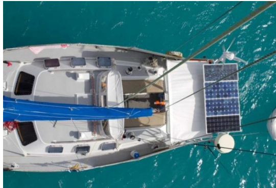
Şekil 2.113. Teknenin kıç tarafına yerleştirilmiş güneş panelleri
