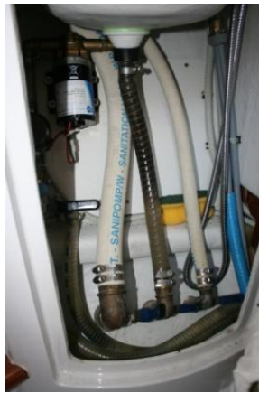
Şekil 2.123. Tuvalet giriş ve deşarj vanaları
