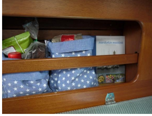
Şekil 2.89. Ara çita ile malzemelerin dökülmesinin engellenmesi
