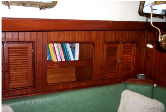
Şekil 2.88. Kitapların düşmesini engelleyecek bir raf sistemi
