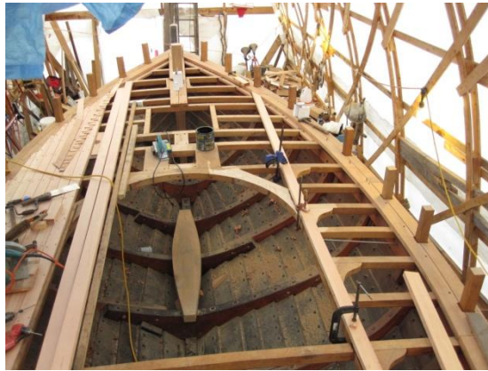
Şekil 1.35. Kemereler üzerine güverte kaplamalarının montajı
