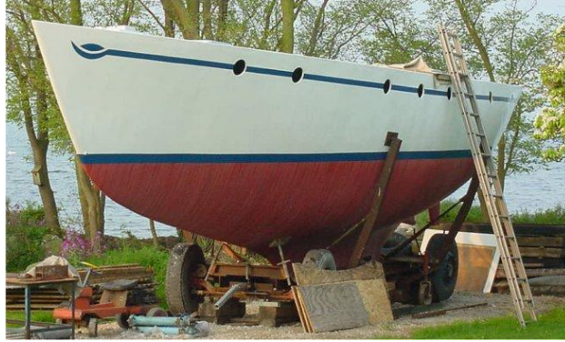
Şekil 1.48. Beton yapım yöntemi ile üretilmiş yelkenli gövdesi
