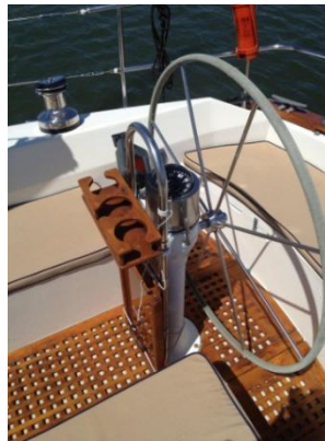
řekil 2.107. Havuzluk zemininde bulunan ızgara taban
