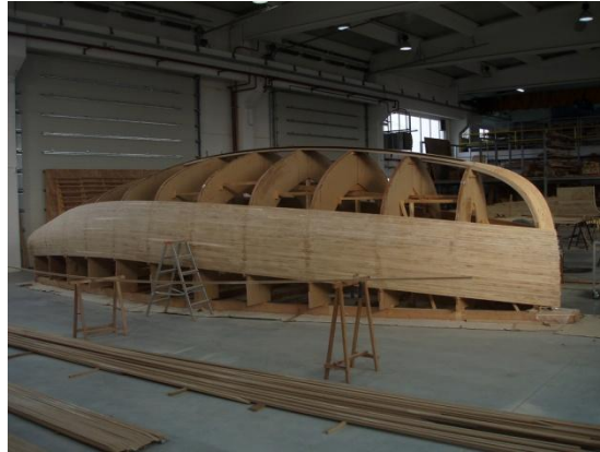
1.34. Omurga ve postaların oluşturduğu iskeletin kaplanması
