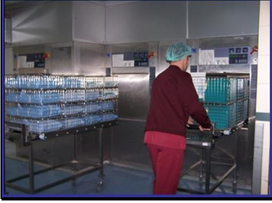
Malzemelerin sterilizatöre yerleştirilmesi
