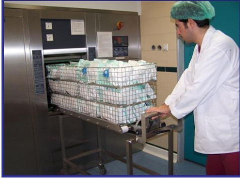
Malzemelerin sterilizatöre yerleştirilmesi
