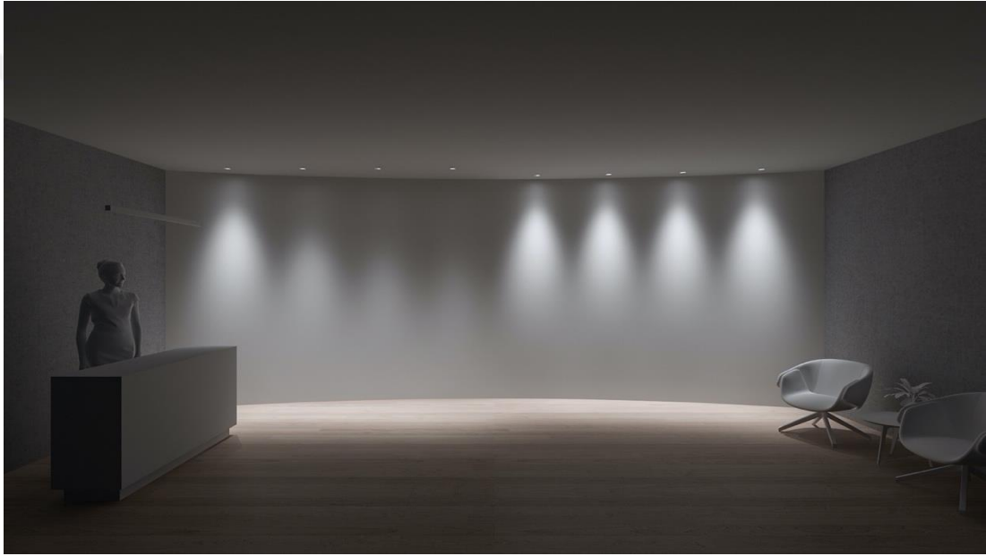
Şekil 3.6a: Dairesel bir yüzey üzerinde farklı yerleşim düzenine sahip armatürlerin oluşturduğu ışık etkisinin sanal ortamdaki üç boyutlu simülasyonu. (Tasarım: ÇAĞAL TAŞDELEN, D., 3b görselleştirme: TAŞDELEN, A.)
