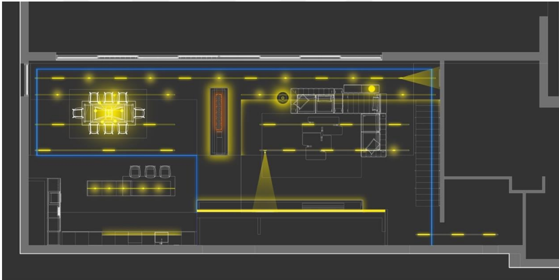
Şekil 3.7c: Işığın mekâna ait bölümler üzerindeki etkisinin planda gösterimi. (Tasarım: ÇAĞAL TAŞDELEN, D., 3b görselleştirme: TAŞDELEN, A.)
