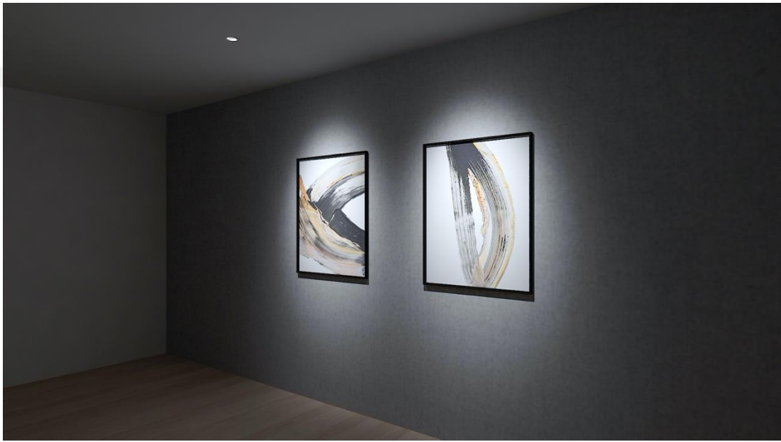
Şekil 3.22b: Downlight armatürün sağladığı ışık etkisi simülasyonu ve armatür teknik özellikleri. Armatürün doğrultusu tek başına yüzeydeki ışık etkisini değiştirmek için yeterli olabilmektedir. Downlight armatür ışığı duvar yüzeyine göndermemekte, direkt (doğrudan) zemine uygulamaktadır. Armatürden çıkan ışığın oluşturduğu hüzmelerin etkisi duvarda görülmektedir.
