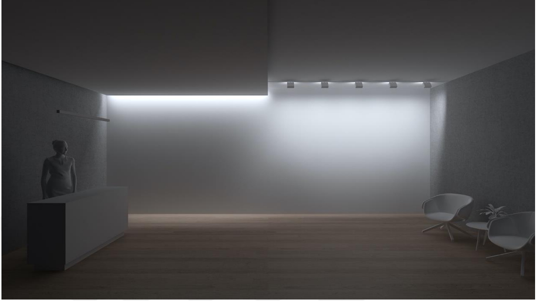
Şekil 3.2: Farklı tipte iki armatür ile yapılan ışık uygulamasında, beyaz boyalı mat yüzeyin ışığı yansıtma simülasyonu.
