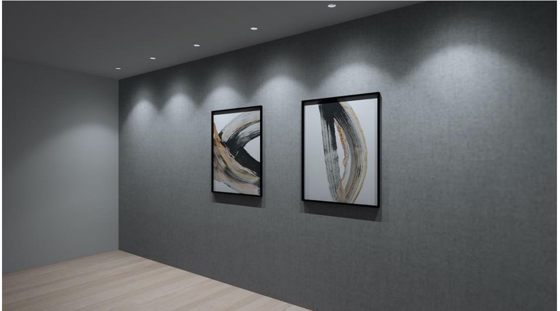
Şekil 3.22a: Wallwasher armatür ışık etkisi simülasyonu ve armatür teknik özellikleri. Armatürün, yüzey üzerinde sağladığı ışık etkisi, yaydığı ışığın doğrultusunun, konumunun, açısının, lümen değerinin, vb. teknik özelliklerinin sonucudur.
