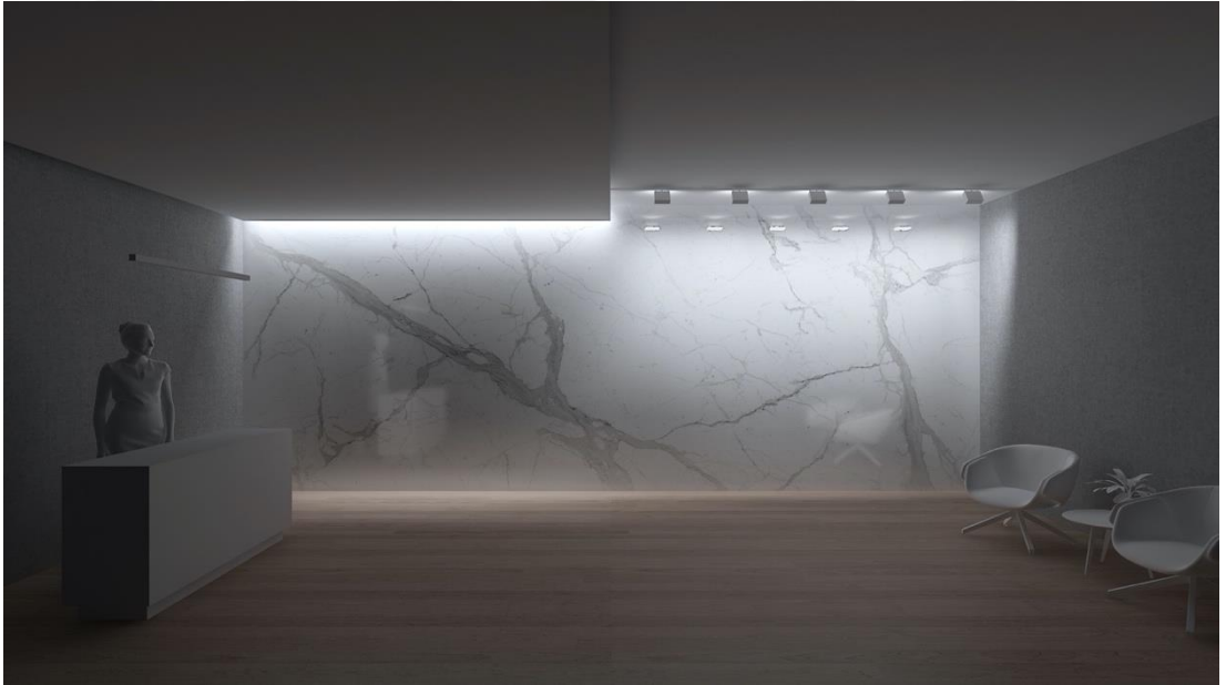
Şekil 3.3: Farklı tipte iki armatür ile yapılan ışık uygulamasında, parlak yüzeyin ışığı yansıtma simülasyonu. (Tasarım: ÇAĞAL TAŞDELEN, D., 3b görselleştirme: TAŞDELEN, A.)
