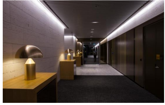
Şekil 3.29: Duvar yıkama efekti. 200
