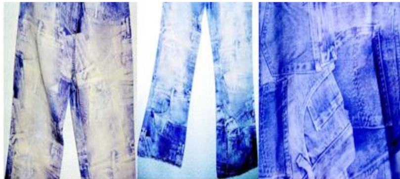
Resim 2.2.g. Taş yıkama ve enzim yıkama yapılmış denim üzerim süblime transfer baskı 52
