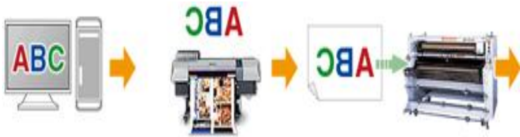
Şekil 2.1a. Dijital süblime kâğıt üretim iş akışı ve desen ters basımı
