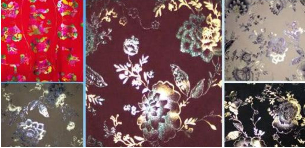
Resim 1.h. Metraj baskıda desen tutkallanmış kumaş üzeri desenli varak transfer baskı örneği.
