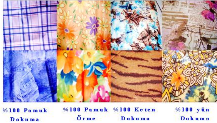
Resim 2.2.e. Süblime transfer baskı kâğıdı basılmış doğal kumaş neticeleri 50
