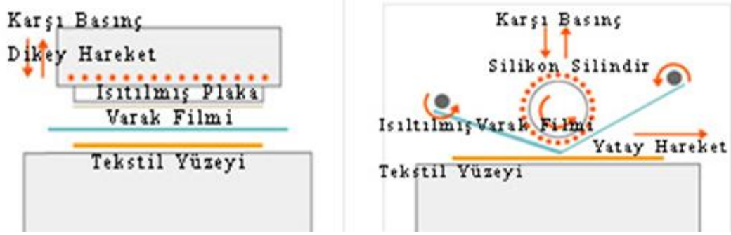
Şekil 1.f. Varak Kâğıdının tekstil yüzeyine aktarım şeması
