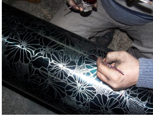
Resim 2.1.h. Tifdruk baskı silindir yüzeyinin pozlama sonrası rötuşlenmesi
