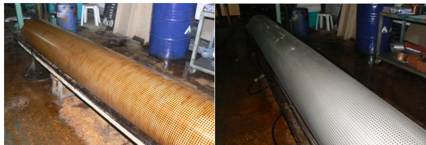
Resim 2.1.i. Tifdruk baskı silindirininin krom kaplama öncesi ve sonrası
