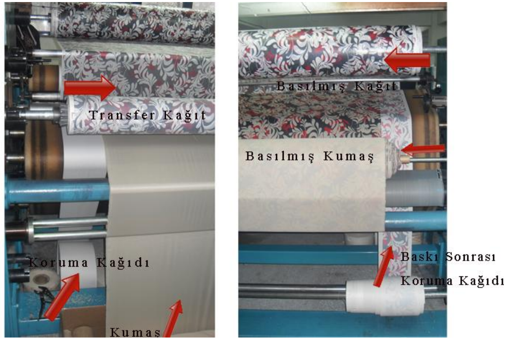
Resim 2.2.a Transfer baskı makinesinde kumaşın koruma kağıdı ile birlikte basım uygulanması
