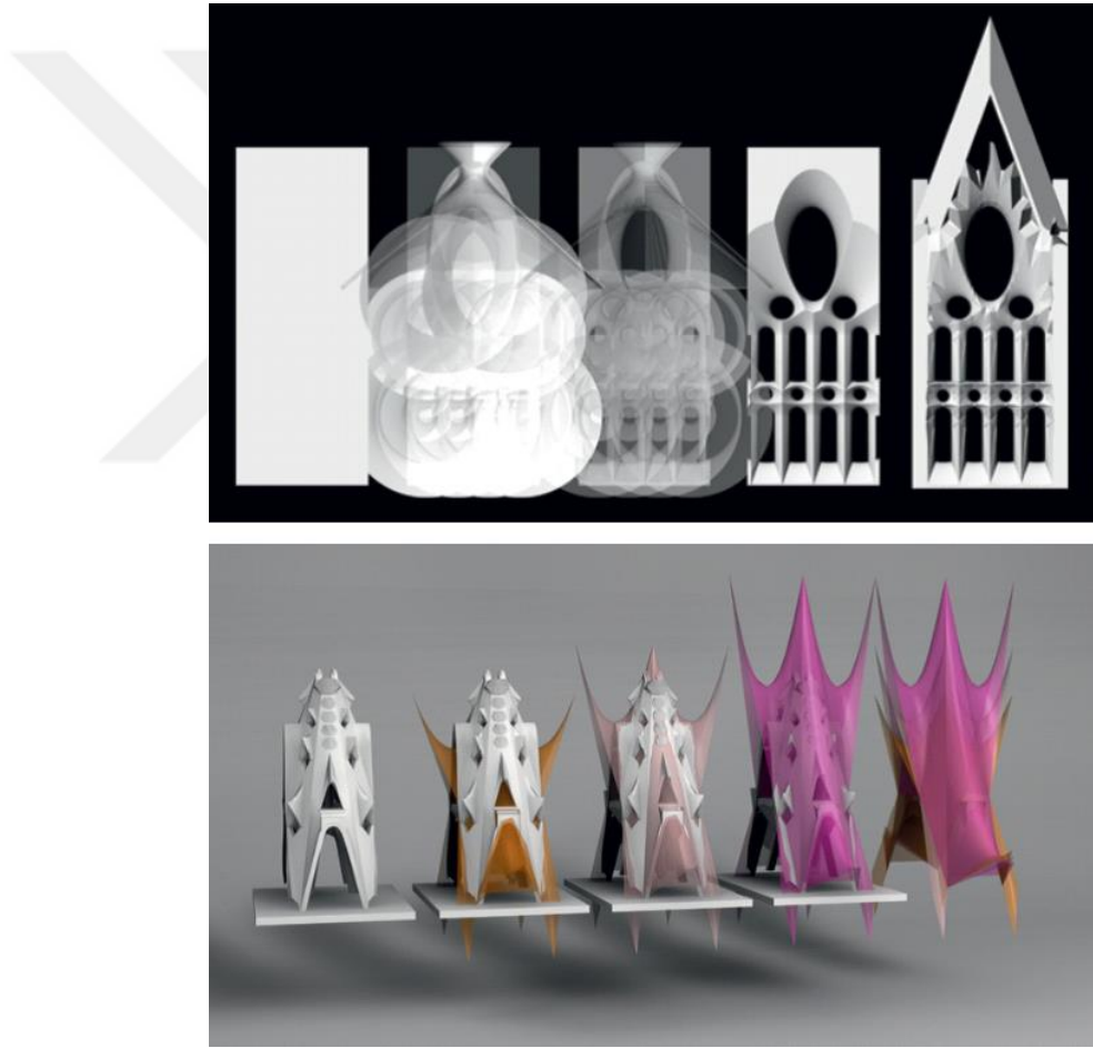
Şekil 3.4.2.1: Sagrada Familia Kilisesi'nde form oluşturma süreci için doğru değer kombinasyonunu bulma işlemi (Burry ve diğ. 2008: Makert ve diğ., 2016)
