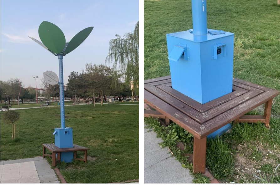
Resim 5.14: Marmara Bölgesi belediyesinde bulunan alternatif enerjili kent mobilyası örneği (K. Sert, 2022).
