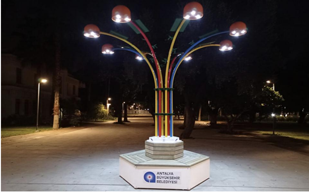
Resim 5.2: Antalya Belediyesi'nde kullanılan güneş enerjili aydınlatma ve bank örneği (URL 19).
