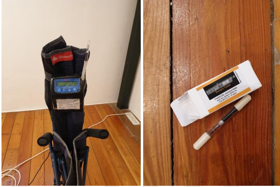
Şekil 18: Örneklem Düzeneği ve Sorbent Tüpü
