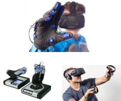
Şekil 3. Sanal Gerçeklik (VR) etkileşim (interaction) ve duysal geribildirim (sensory feedback) donanımları ( http://www.vrotto.com ) (URL-2)
