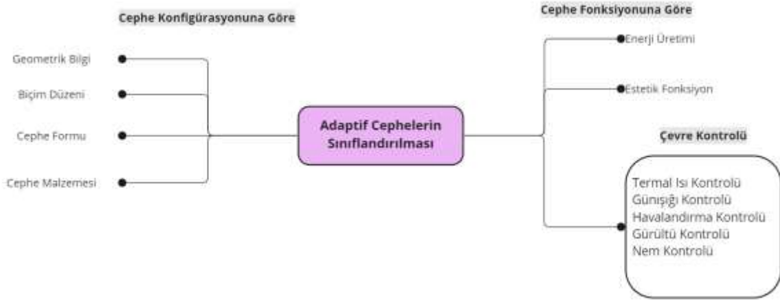
Şekil 2. 4: Ana ve alt kategoriden oluşan Kinetik Cephe Şeması (Waseef and El-Mowafy, 2017).
