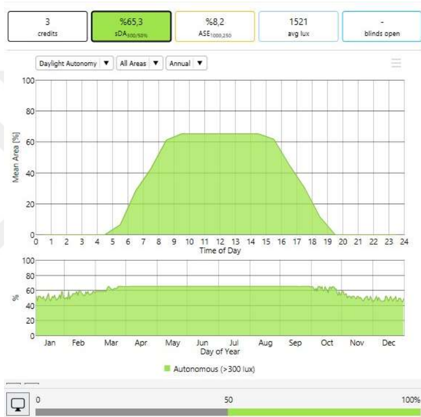
Şekil 4. 27 : Daylight Availability (DAV) analiz sonucu.
