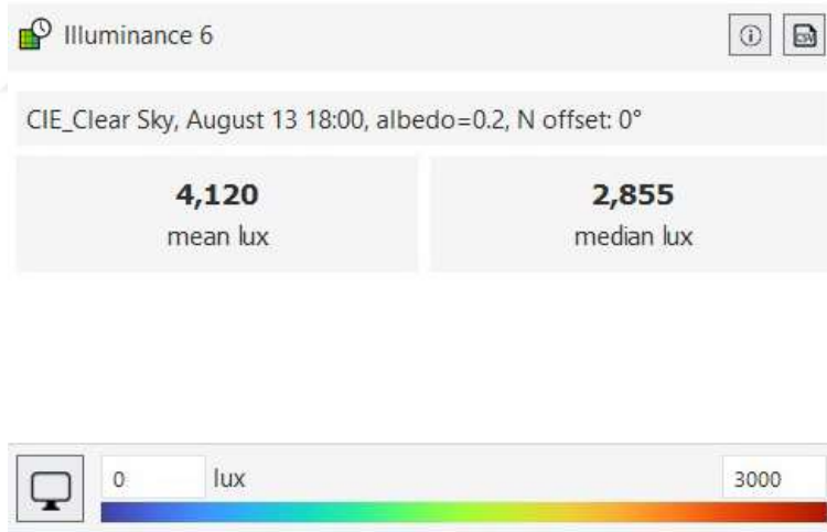
Şekil 4. 26 : Aydınlık düzeyini gösteren analiz sonucu (13 Ağustos, 18:00).
