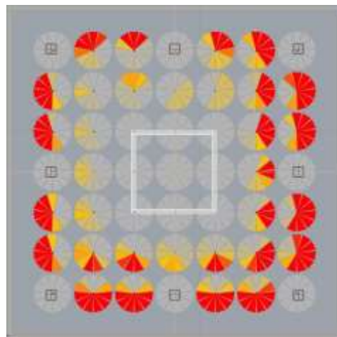
Şekil 4. 39 : Plan düzleminde günışığı kamaşma analiz gösterimi (13 Ağustos, 09:00).
