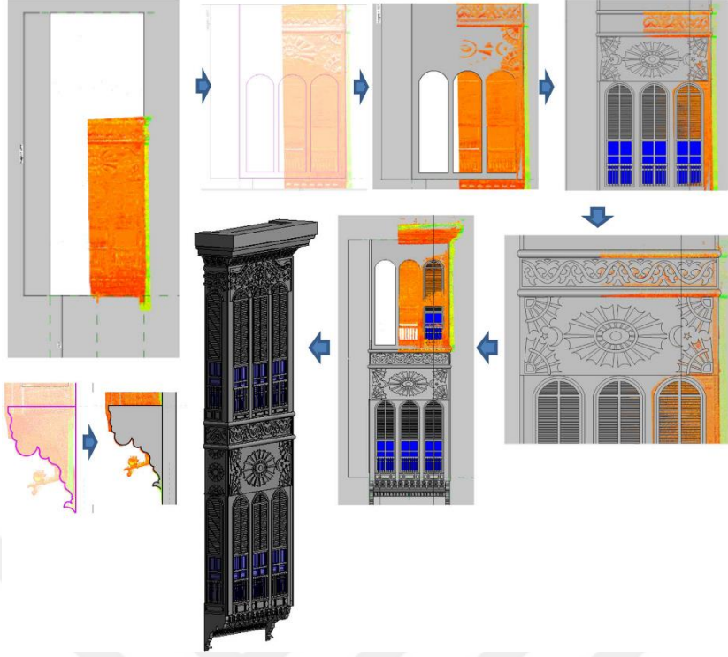
Şekil 3.20: Nasif tarihi evine ait temel Roshan modellemesinin aşamaları (Baik, 2017).
