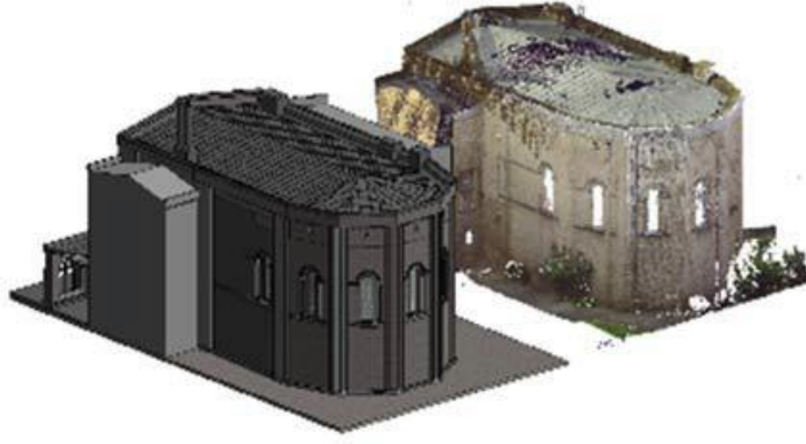
Şekil 3.6: Nokta bulutundan sonra Revit programından elde edilen 3 boyutlu model-Solda (Tapponi ve diğ., 2015).
