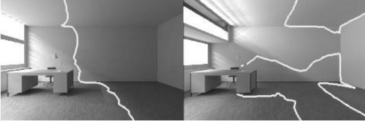
Şekil 3.7: LESO Binası Kontrollü Anidolik Sistem Deneyi Görselleri(Url-15)
