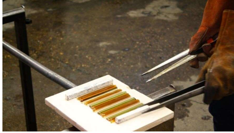
Şekil 3.28. Filigrana Tekniğinin Uygulanması İçin Hazırlanan Cam Çubuklar, Anonim
