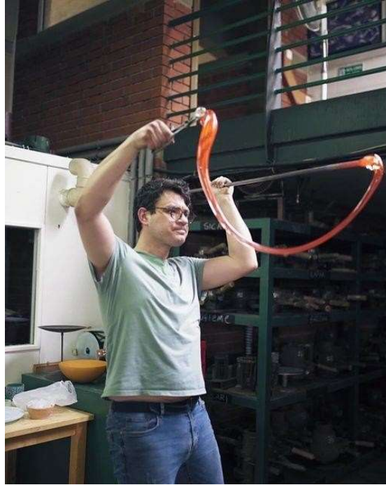
Şekil 3.11. Tek Pipoyla Çubuk Çekme İşlemi
