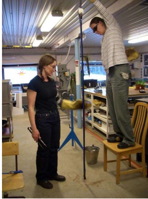
Şekil 3.12. Murrine Üretiminde, Tek Pipoyla Çubuk Çekme İşlemi
