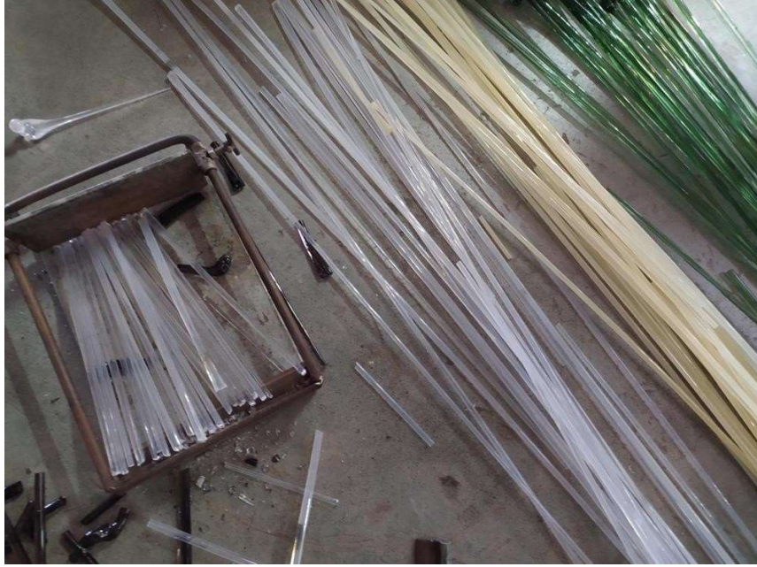
Şekil 5.21. Sıcak Camda Hazırlanan Renkli Cam Çubuklar ve Model Ölçülerine Göre Boyutlandırılmaları
