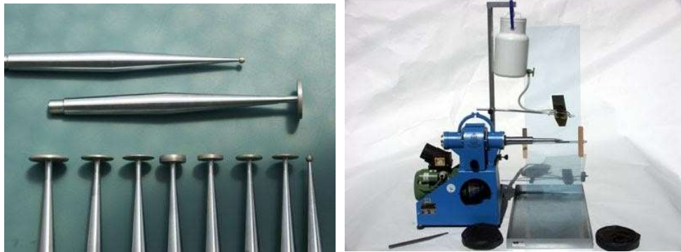
Şekil 3.3. Farklı Çap ve Genişlikte Kazıma Uçları ve Cam Gravür Kazıma Makinesi
