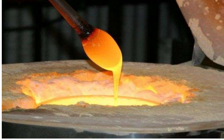
Şekil 3.4. Renkli Cam Eriyiği Bulunan Potadan Cam Sarılması
