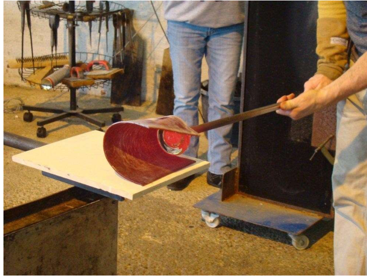
Şekil 3.17. Roll-Up Tekniğinin Uygulanması
