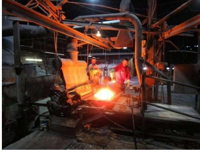
Şekil 2.6: Renkli Plaka Camların Üretiminde Sıcak Camın Döküm Anı
