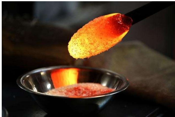
Şekil 2.3: Toz ve Granül Haldeki Renkli Camların Şeffaf Cam Yüzeyine Kaplanması
