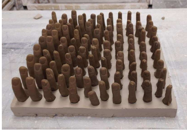
Şekil 5.19. Balmumundan Üretilen Parmakların Kalıplanması
