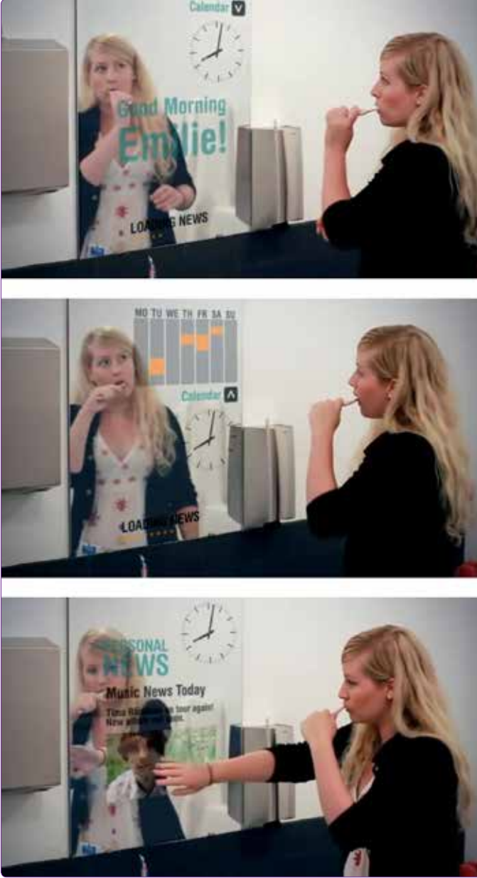
Şekil 7. Kullanıcıyı otomatik algılayan dokunmatik etkileşimli bir ayna tasarımı. 21
