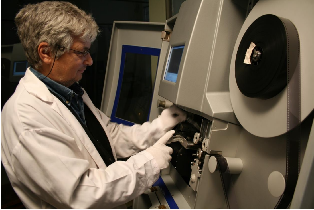
Resim 2.53: Filmin kare kare taranarak dijital ortama aktarılması
