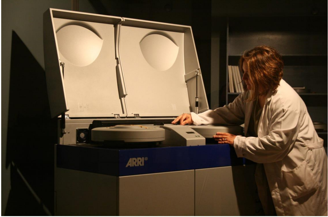
Resim 2.54: Dijital filmin görüntü dosyalarının tekrar film malzemesine aktarılması
