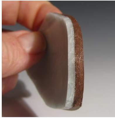
Resim 2.6.1 Pişmiş Buz Çatlağı Sır Kalınlığını Gösteren Kırık Kâse Kesiti.
